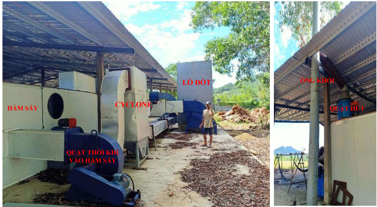
Hình 4.7. Hình ảnh minh họa hệ thống xử lý khí thải lò sấy ván lạng trong thực tế
