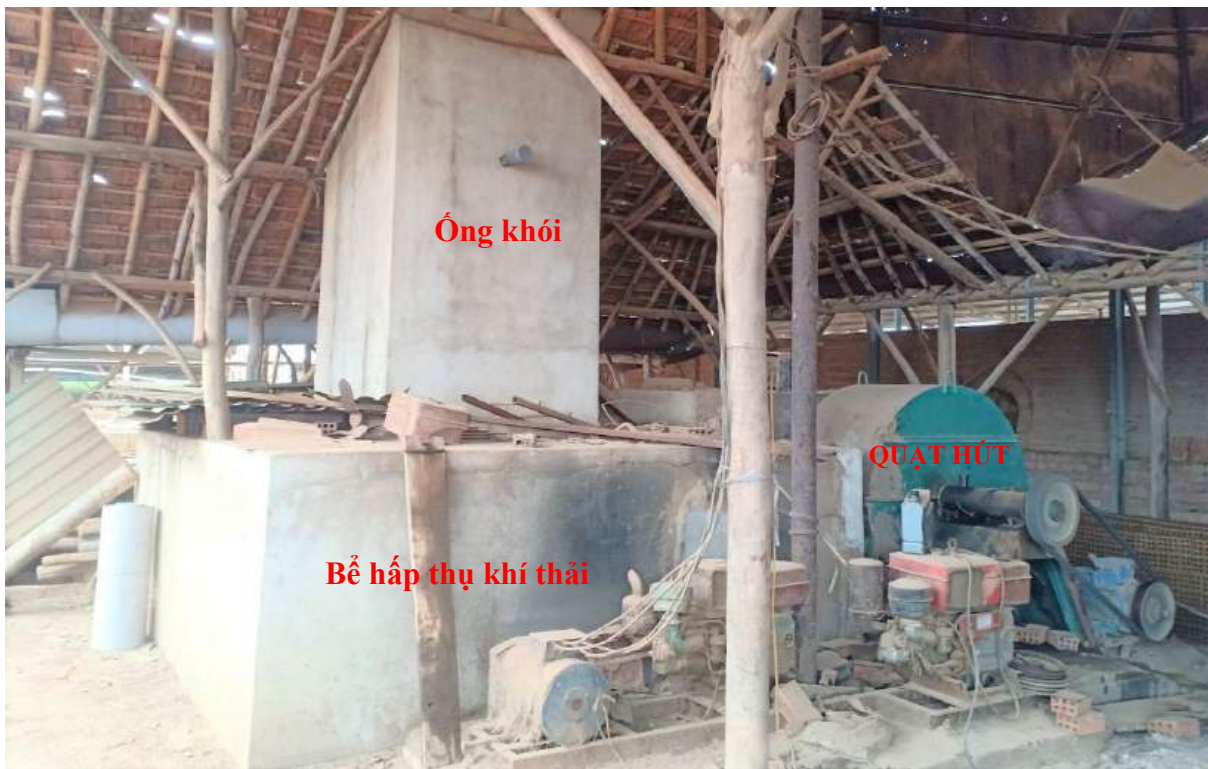
Hình 10. Hệ thống xử lý khí thải lò nung
